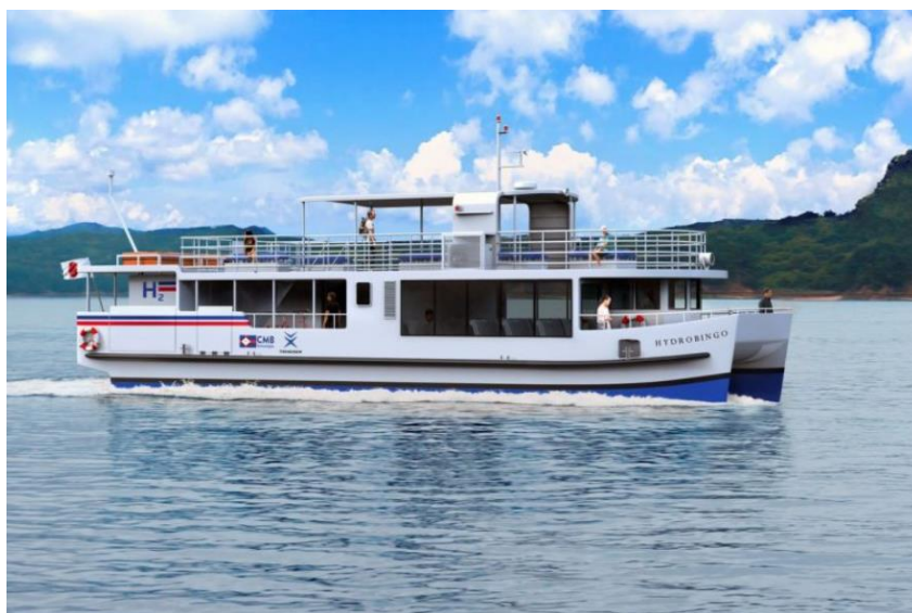
Figura 4.27: Hydrobingo - il primo traghetto ibrido Diesel/Idrogeno per uso commerciale
