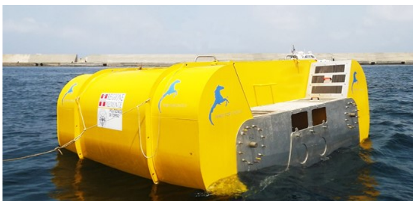
Figura 42: ISWEC (Intertial Sea Wave Energy Converter) - impianto sperimentale generazione elettrica da moto ondoso e FV
